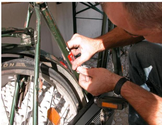
Auf dem eingravierten Code wird ein spezieller Aufkleber angebracht, um den Code noch besser sichtbar zu machen und die Stelle von Korrosion zu schützen.
