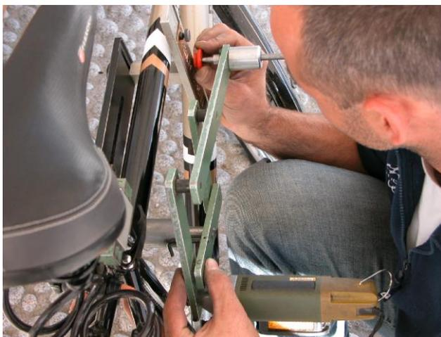
Die Codierung erfolgt mit einem speziellen kleinen Fräsgerät, mit welchem der Sicherheitscode auf
